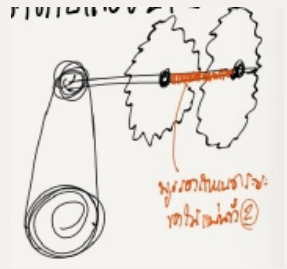
รูปเครื่องเลื่อยวงเดือนติด FEEDER พร้อมติดใบเลื่อย 2 ใบ
