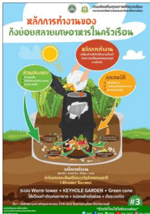
รูปที่ 2-4 หลักการทำงานของถังย่อยสลายเศษอาหาร
