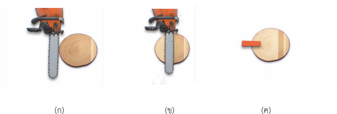
ภาพที่ 2 แสดงขั้นตอนการโค่นล้มไม้ขนาดเล็กด้วยวิธีการตัดจากด้านหลัง (ก) แสดงการบากหน้า, (ข) แสดงลัดหลัง, (ค) ใช้ลิ้มตอก
